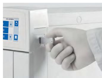
**Svi ciklusi su automatski spremjeni u unutrašnju memoriju sterilizatora te se kasnije mogu prebaciti na USB memoriju i pregledavati na vašem računalu.**
